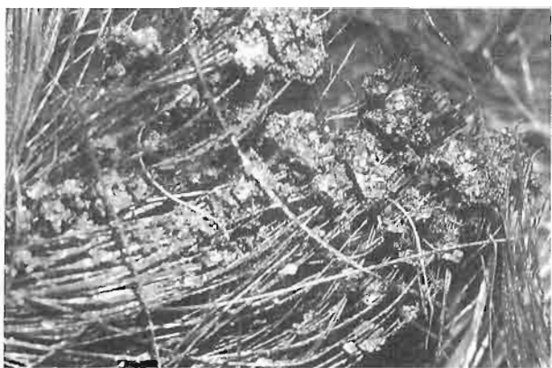
Fig. 3. Extrémité d'une mèche sectionnée et encollée avec de la résine.
